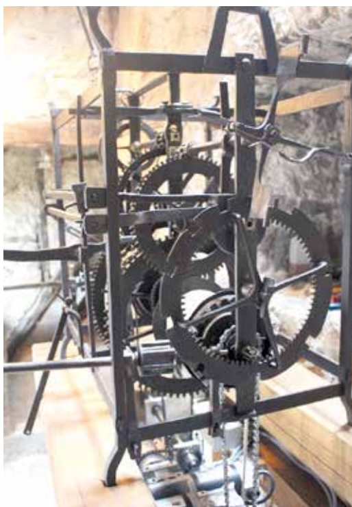
Abb. 9 und 10: Das Uhrwerk mit neuer Technik im Backhaus
