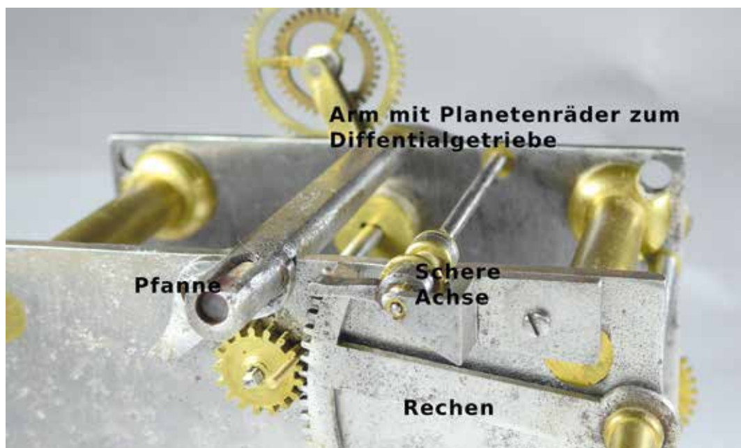
Bild 5: Rückplatine. Das kleine Messingrad befindet sich auf der Achse, die vorne den Arm für die Planeten- räder trägt. Der Rechen ist über die Achse vorne mit dem Abtaster mit Rolle verbunden, der durch die Federspannung von dem Federhaus auf der Innenseite der Vorderpla- tine auf die Nierenscheibe gedrückt wird. Sichtbar auch die Pfanne aus Achat für die Schneide der Pendelaufhängung, und die Achse der Schere mit dem kleinen Hebel für die Pendelanregung.
