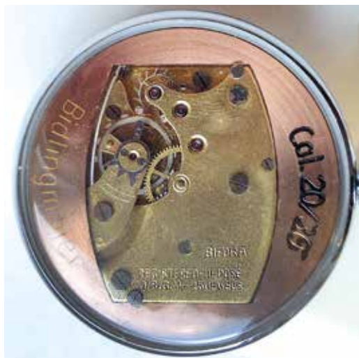
Abb. 4, links: Das erste in Deutschland von Bifora entwickelte und ab 1928 gefertigte Armbanduhrenwerk Kaliber 2025
