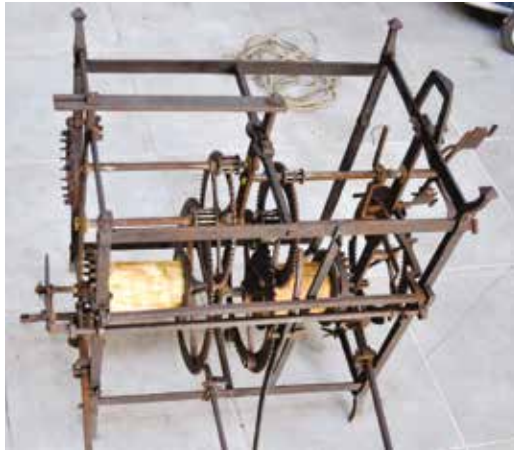
Abb. 7, links: Zustand des Uhrwerkes noch dem Trocknisreinigen
