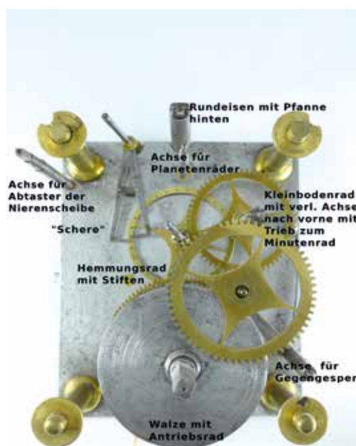
Bild 9: Das Antriebswerk. Die „Schere“ wird ungewöhnlicherweise seitlich gelagert.
