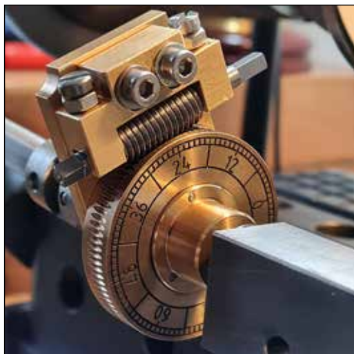
Abb.8 (links): Phasenversteller zum definierten Verschieben der Rosettenmuster
