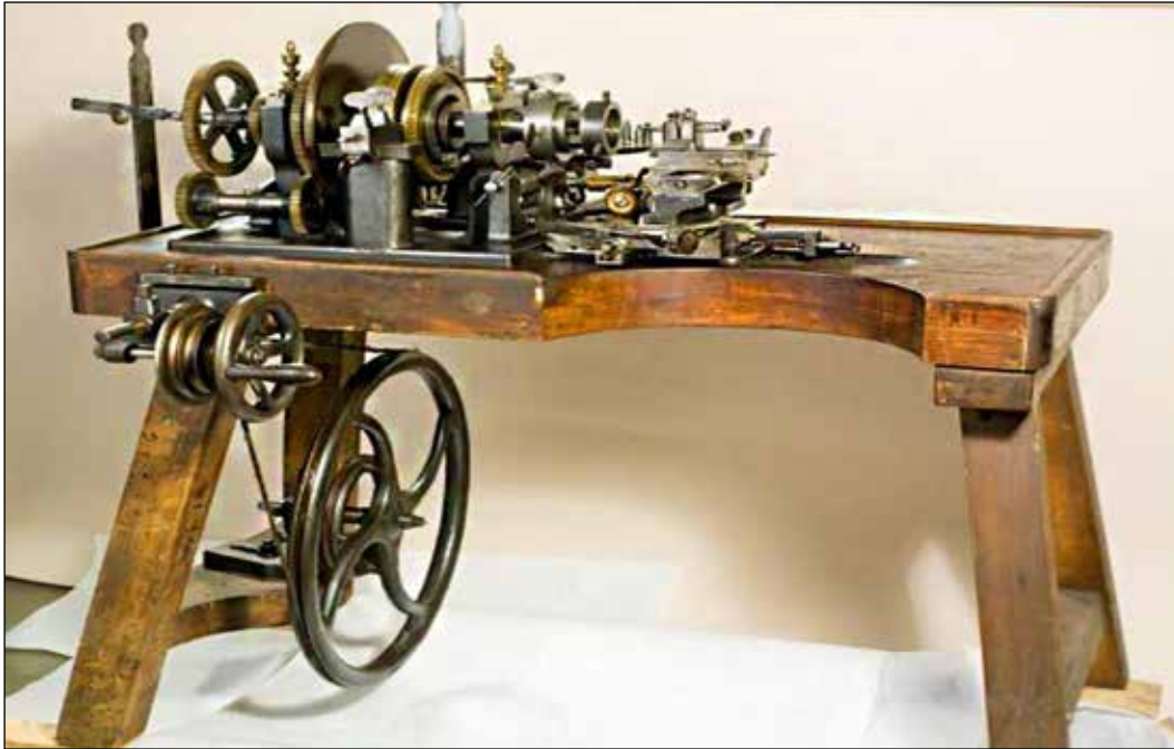
Abb.3: Eine Rundzugmaschine für Guillochierarbeiten
