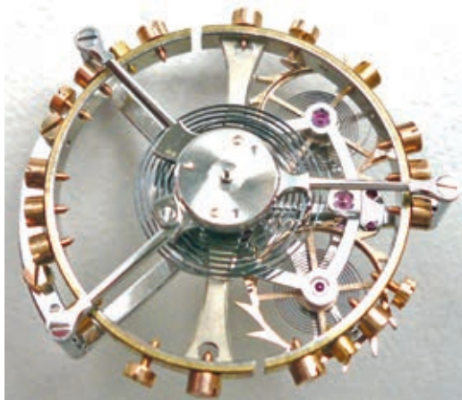
Abb. 5, rechts: Tourbillon „Gemini“ mit zwei Hemmungen und Unruhen
