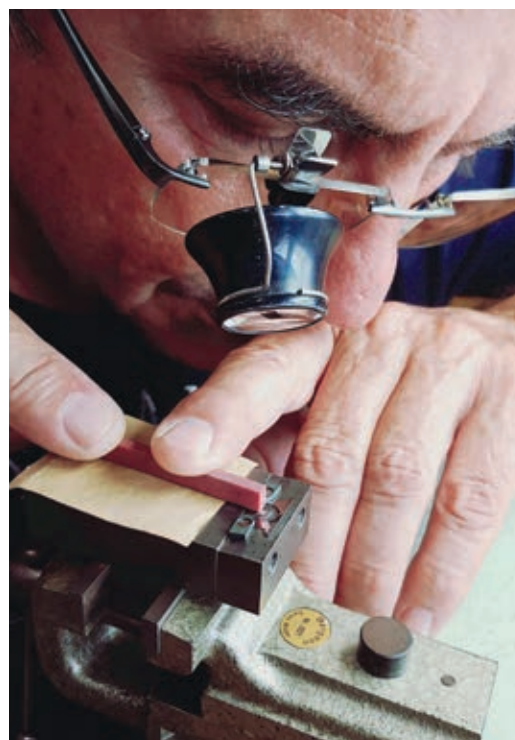
Abb. 15, links: DR01-Workshop - Renaud beim Bauen eines Modells von der Hemmung ohne Spirale der DR01
