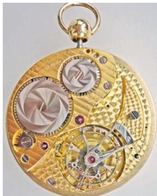
Abb. 4 und 4a: Taschenuhr mit Tour- billon nach Derek Pratt (Ankerhemmung über zwei Hemmungsräder mit konstanter Kraft auf einen Anker)
