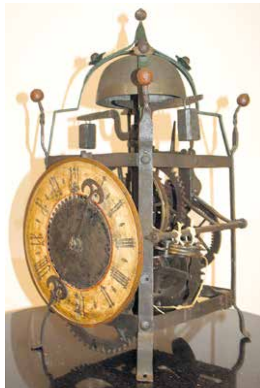
Abb. 3, links: Die beiden äußeren Lagerbänder wurden beim Umbau der Hemmung nach oben verlängert
