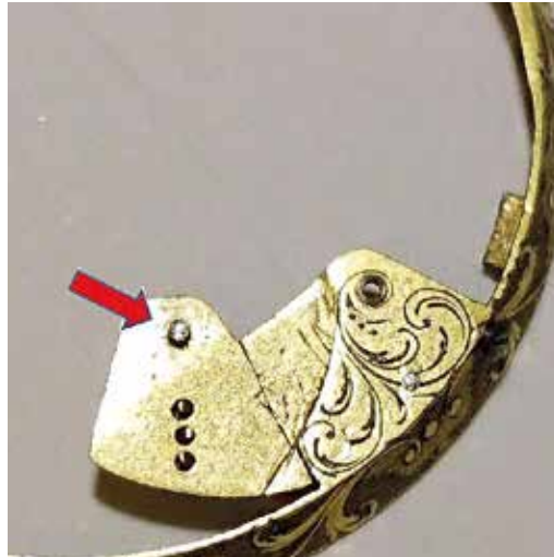
Abb.8: Die Lagerung für die Jahresanzeige
