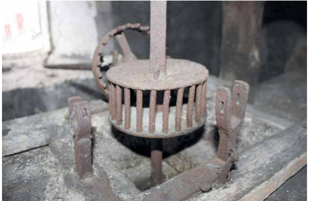
Abb. 13: Das Zeigergetriebe gab die Minutenbewegung an die drei Zeigerwerke hinter den Zifferblättern weiter
