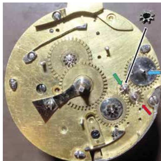
Abb.6: Fixierung des Zifferblatts mit drei seitlichen Schrauben
