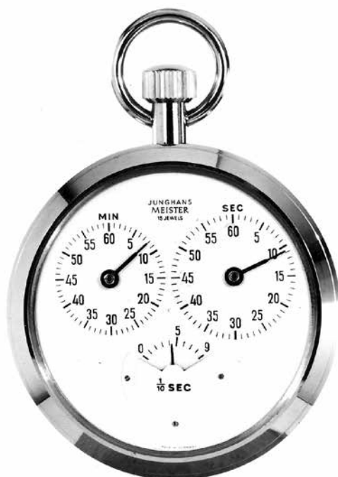
Abb. 1a, links: Junghans Dreikreis-Stoppuhr für 1/10 Sekunden, Zifferblattansicht
