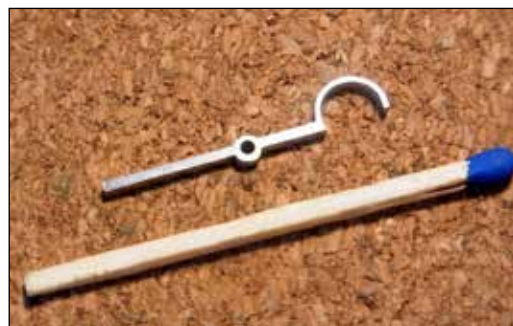
Abb. 10: Der Auslösearm für die Petohemmung
