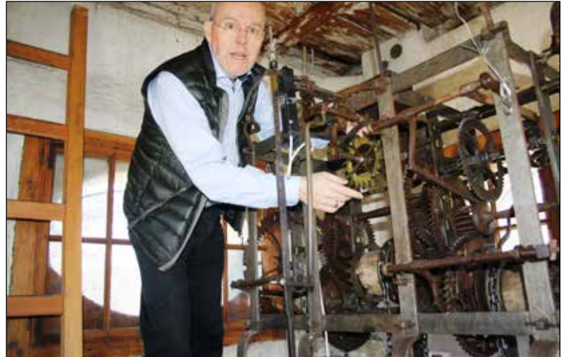
Abb. 5 (links): Die Domuhr 1782 von Johann Bentele sen. ist außer Betrieb, aber funktionsfähig. Das größte historische Turmuhrwerk im Land Salzburg ist 206 cm breit. (© Domkirchenfonds Salzburg, Michaela Hessenberger)
