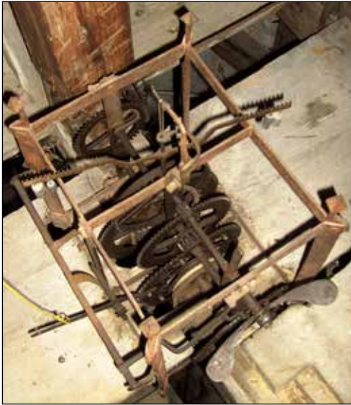
Abb. 2 (links): Das Turmuhrwerk der Antoniuskapelle von Schloss Haunsperg in Oberalm stammt aus dem ausgehenden 16. Jahrhundert und ist nach mehr als 400 Jahren betriebsbereit.
