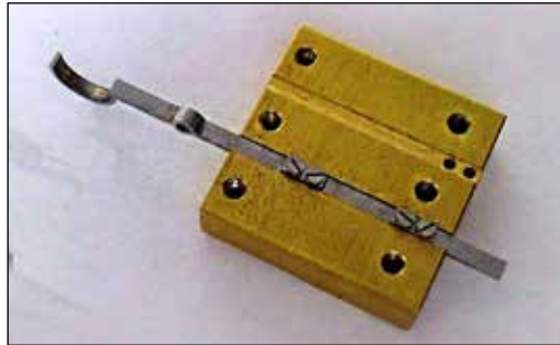
Abb. 12: Der fertige Auslösearm mit Biegefeder
