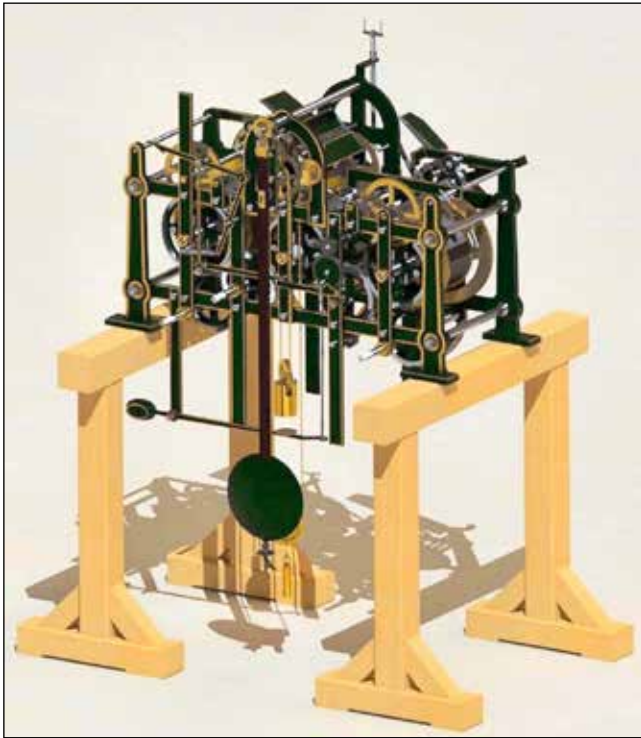
Abb. 14: Der digitale Nachbau des Turmuhrwerks 1912 des Borromäums in Salzburg am Bildschirm (© Elisabeth Willau)
