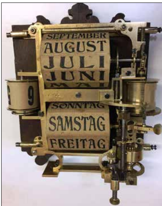
Abb.9 (re.) Detaildarstellung verschiedener Schlüsselkomponenten im Kalenderwerk
