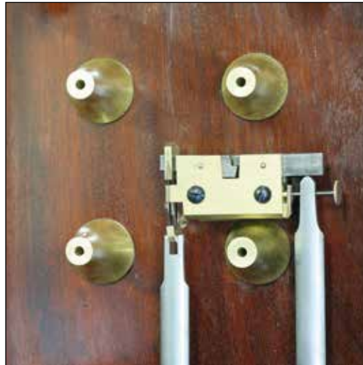
Werkhalterungen und Pendelaufhängung mit Kompensationsstange
