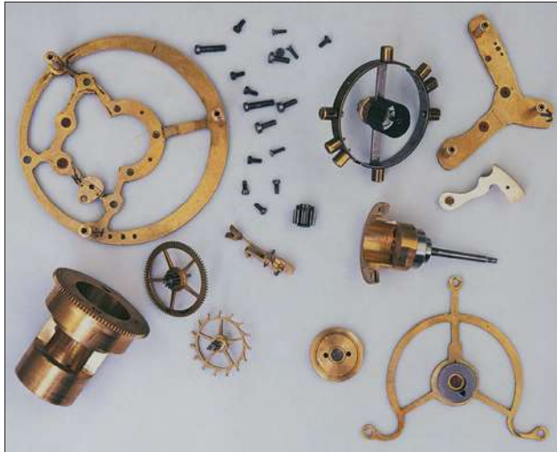
Abb. 7 Federhaus, Minutenrad, Zwischenrad-Zahnkranz zum Aufsetzen auf Turm, Ankerrad (Hemmungsrads), Sekundenrad, Zeigerwerktrieb, Übertragungstrieb.
