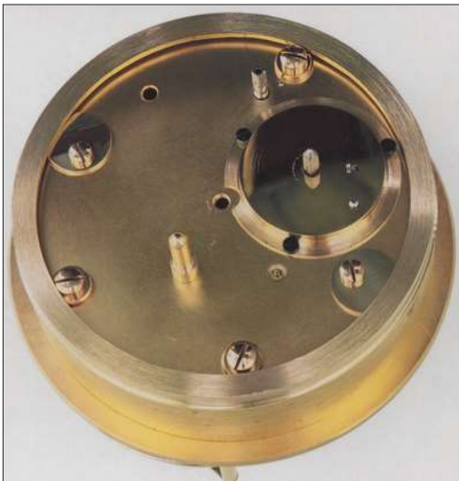
Abb. 13 Fertige Werkrückseite nach der körnigen Versilberung und Hartvergoldung
