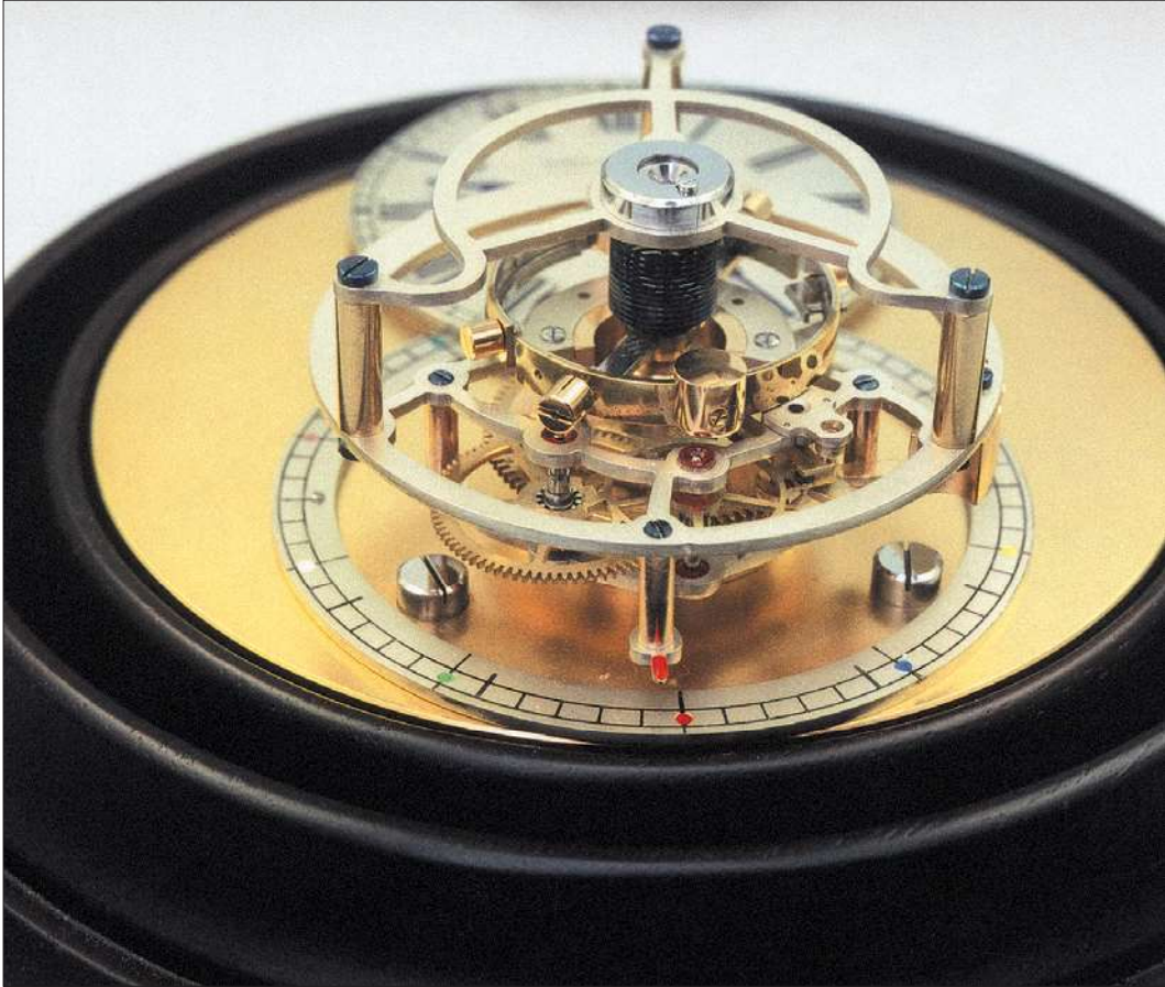
Abb. 15 Werkansicht, es ist geschafft und das Regulieren kann beginnen. Der rote Zeiger ermöglicht die sekundengenaue Einstellung. Der Abstand der Farbpunkte entspricht einer Minute und ist in sechs mal zehn Sekunden unterteilt. Ein Umlauf des Drehgestells entspricht zehn Minuten. Die Feinreglage erfolgt wie beim Marinechronometer durch Abgleich der Unruhschrauben.
