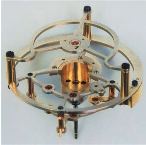
Abb. 11 und 12 Zwei Ansichten vom fertigen Drehgestell vor der Endmontage. Die Teile sind körnig versilbert und mit Anlaufschutzlack gesprüht
