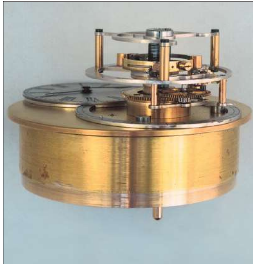
Abb. 14 Das Werk hat eine Staubschutzkapsel, hier die komplette Ansicht des Werkes
