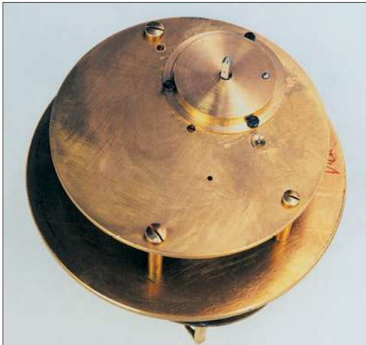
Abb. 2 Grund- und Rückplatte mit aufgesetztem Gesperr
