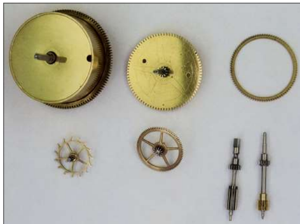
Abb. 7 Federhaus, Minutenrad, Zwischenrad-Zahnkranz zum Aufsetzen auf Turm, Ankerrad (Hemmungsrads), Sekundenrad, Zeigerwerktrieb, Übertragungstrieb.
