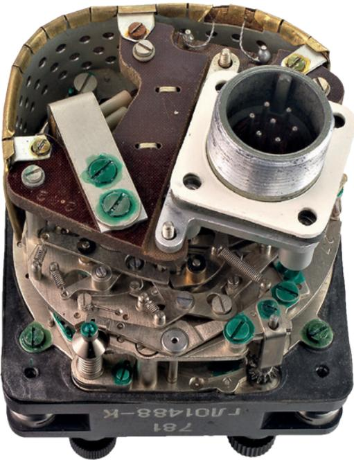
Abb. 54 Schaltmechanismus »Modell 781«
