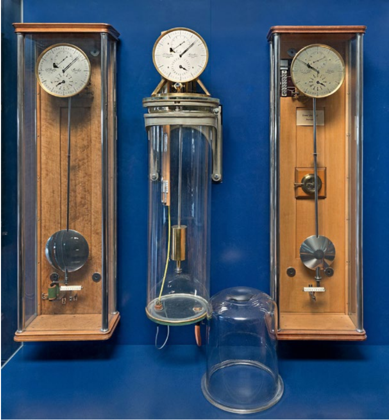
Abb. 12: Zeitdienst- anlage im Deutschen Museum mit Hauptuhr Nr. 98 im Glastank und zwei Nebenuhren (Foto: Jürgen Ermert – Deutsches Museum)
