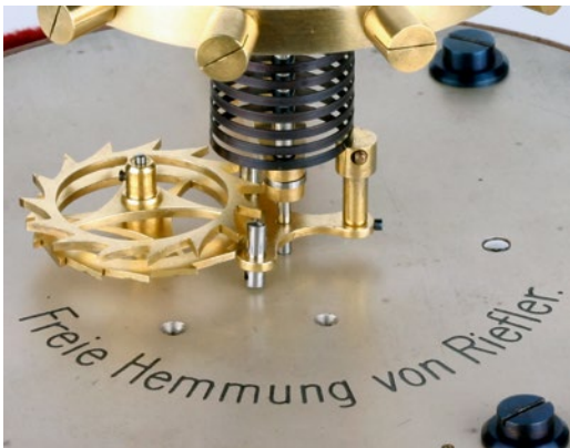
Abb. 3: Modell für neue Hemmung mit völlig freischwingender Unruh und Antrieb über Spiralklötzchen (Foto: Deutsches Uhrenmuseum, Inv. 2011-026)
