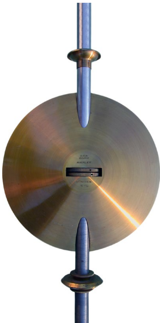
Abb. 5: Quecksilber-Kompensations-Pendel von Riefler (Foto: Jürgen Ermert)
